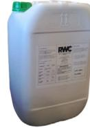
Dosificación : Entre 1 % y 1,5 % del peso del cemento. Se recomienda añadir el aditivo al agua de amasado o al hormigón previamente amasado. En este caso hay que seguir amasando para obtener un buen reparto del aditivo en la masa del hormigón al menos 1 minuto más por cada m<sup>3</sup> de hormigón.
