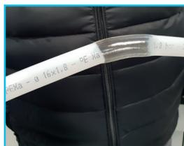
Las tuberías SharkBite PEXa EVOH debido a su excelente memoria térmica absorben el aumento de tamaño debido a la congelación. La reticulación por el sistema PEXa (método peróxido), permite que se expanda (por el aumento de volumen debido a la congelación) y absorba gran parte de la energía de expansión del proceso de congelación. Ninguna tubería es completamente inmune a la congelación, pero la tubería SharkBite PEXa EVOH de RWC es extremadamente resistente a daños de congelamiento.
